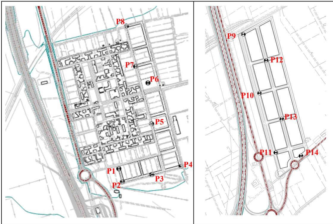
**Figura 13. Puntos receptores para evaluación acústica**
