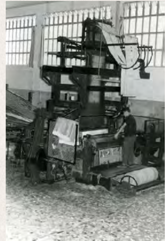
Telar de varilla automático de origen belga. En ese momento está produciendo alfombras de Disney, década años 60. Archivo Fotográfico Alfombras Imperial.
