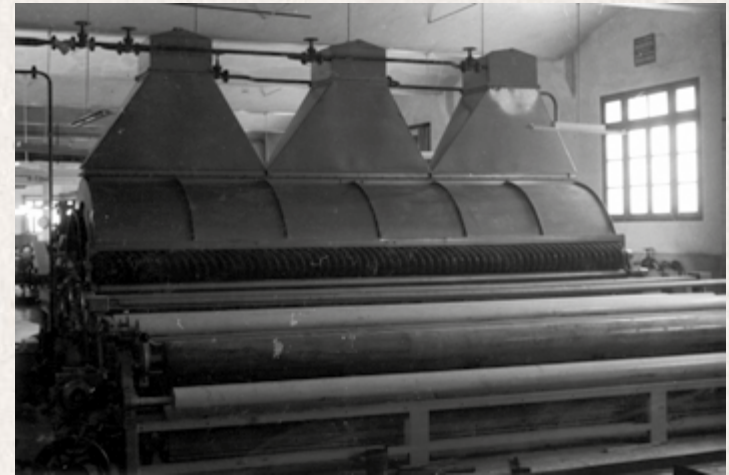
Fig.59. Máquina de bombo para apresto de las alfombras, finales de los años 60
