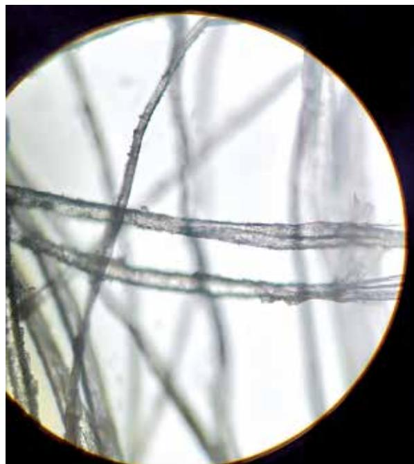
Figura 11. Detalle material constituyente bajo el microscopio óptico en la escultura “Cristo de la Torre”: posible estructura de caña
