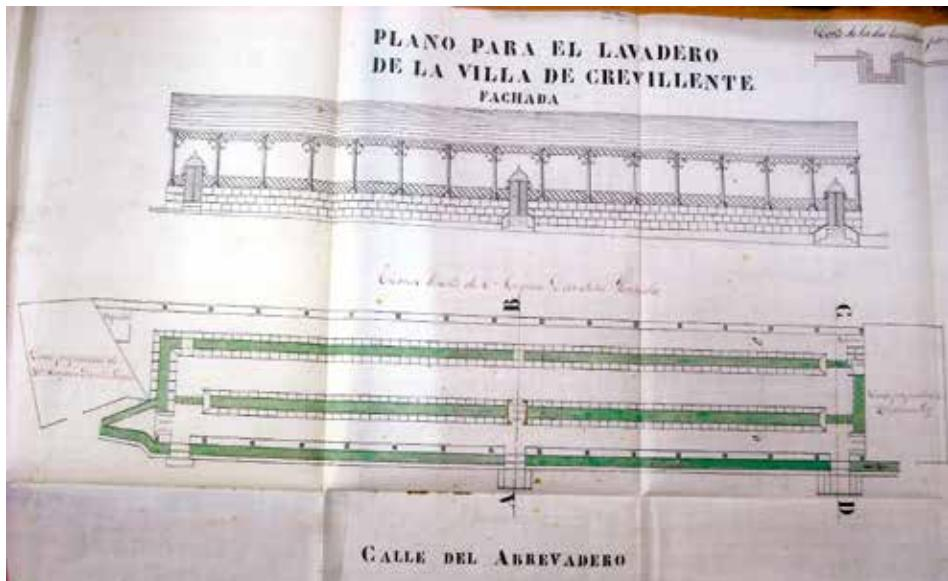
Fig. 18 Planta y alzado del proyecto del Lavadero de 1884 firmado por José Guardiola Picó.
