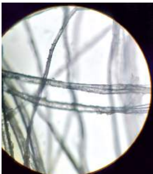
Figura 11. Detalle material constituyente bajo el microscopio óptico en la escultura “Cristo de la Torre”: Posible estructura de caña
